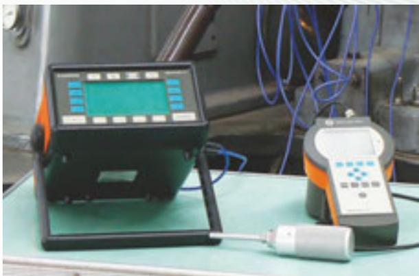
Регулярная диагностика оборудования с использованием накопителя данных, с целью постоянного контроля уровня вибраций, независимо от количества контролируемого оборудования. Длительное хранение данных в компьютере, определение закономерностей, отслеживание изменений состояния после проведения ремонта и т.п. Параллельный "on-line" контроль до 16 измеряемых параметров для детального анализа работы сложных узлов, прежде всего у паровых и газовых турбин.
